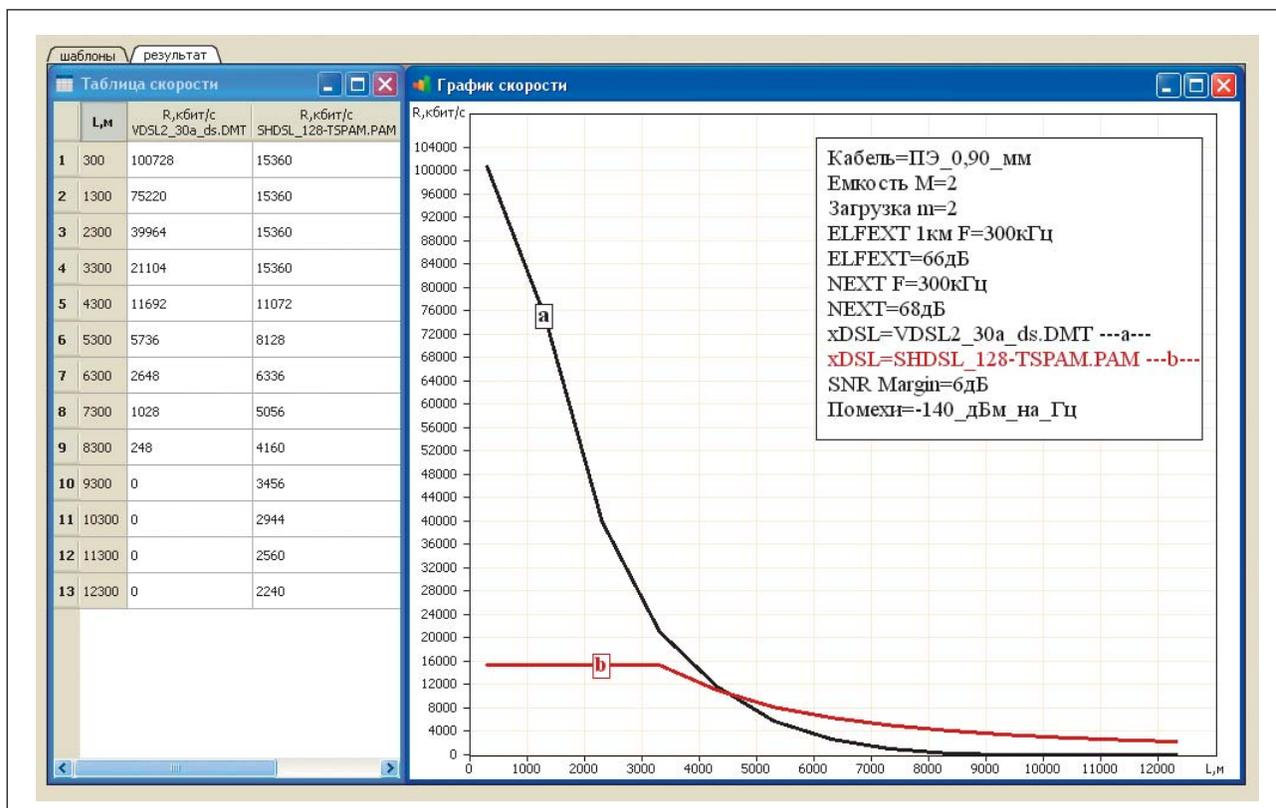
Рис.5. Расчет скорости для цифровой линии VDSL2 (конфигурационный профиль 30a) (a) и SHDSL 128-TSPAM (b)
