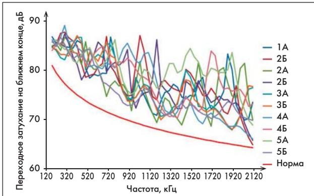
Рис.1. Частотные зависимости переходного затухания на ближнем конце для пяти бухт кабеля ТЦПП 2×2×0,52, измеренные с двух концов. Норма на измерительной частоте для двух пар NEXT<sub>n</sub> (300 кГц, 2) = 77 дБ
