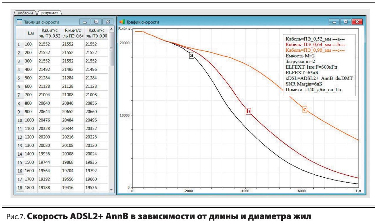
Рис.7. Скорость ADSL2+ AnnB в зависимости от длины и диаметра жил
