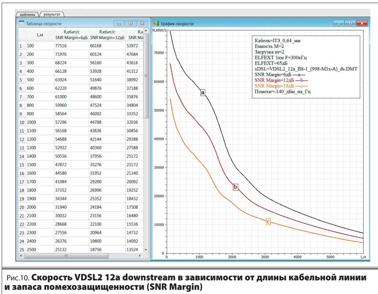
Рис.10. Скорость VDSL2 12a downstream в зависимости от длины кабельной линии и запаса помехозащищенности (SNR Margin)
