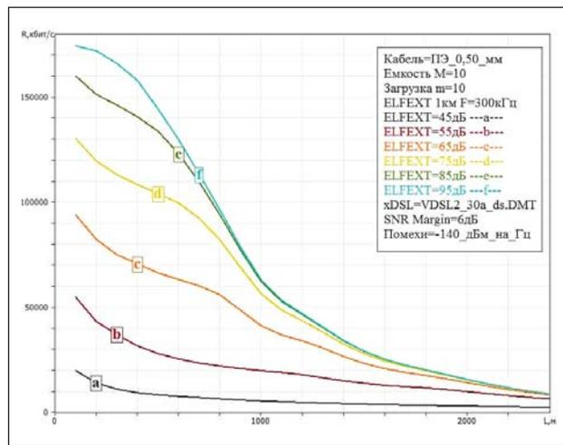
Рис.8. Ограничение скорости VDSL2 30a downstream защитенностью от переходных помех на дальнем конце
