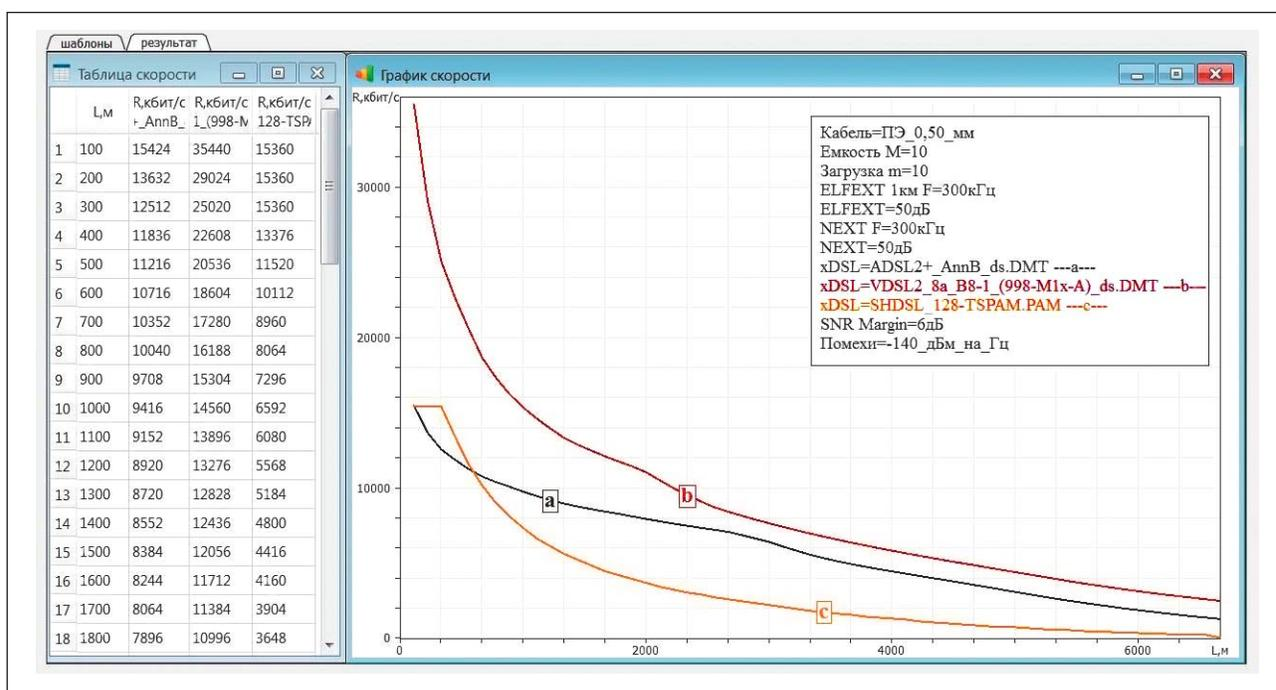
Рис.6. Скоростные характеристики ADSL2+ AnnB downstream, VDSL2 8a downstream и SHDSL 128 TC-PAM на кабеле ТПП 10×2×0,5 при цифровой нагрузке всего 10-парного пучка, нормах переходных влияний NEXT<sub>n</sub> (300 кГц) = 50 дБ и ELFEXT<sub>n</sub> (300 кГц, 1000 м) = 50 дБ, запасе SNR Margin = 6 дБ и спектре помех -140 дБм/Гц. Характеристики переходных влияний кабеля соответствуют уровню требований рекомендации ITU-T L.19 [12]
