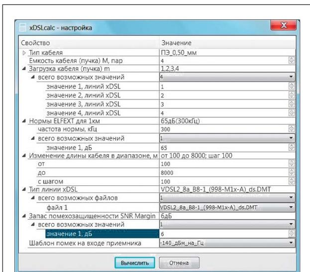
Рис.3. Пример ввода исходных данных (форма "xDSLcalc – настройка")
