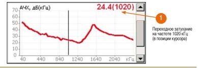
4) Корреляционный **рефлектометр** позволяет выявить дефекты кабельных пар на фоне сигнала, передающегося со стороны ATC:
