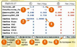
**Дополнительно** отображается количество и % секунд авар<mark>ий ил</mark>и текущее проскальзывание в битах и циклах:
