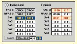
Контроль Sa-битов возможен в двух направлениях, подключенных к входам E1-A, E1-B.
