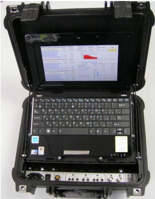
Допускается подключение к анализатору 1-го, 2-х или 3-х внешних блоков коммутации А-7-БК / 200, что обеспечивает выбор одной пары из 200, 400 или 600 соответственно
