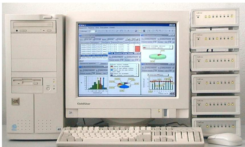
Комплекс AnCom ПАИК-КПВ построен на базе модемов семейства AnCom, дополнительно оснащаемых измерительным КПВ-интерфейсом, и состоит из измерительной станции и автоответчиков, которые отвечают на поступающий сигнал вызова тональным одночастотным сигналом. Измерительная станция (ИС) ответственна за организацию и проведение измерений. В ее состав входят:
