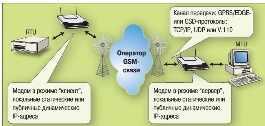
**Рис. 3. Радиоудлинитель интерфейса**
