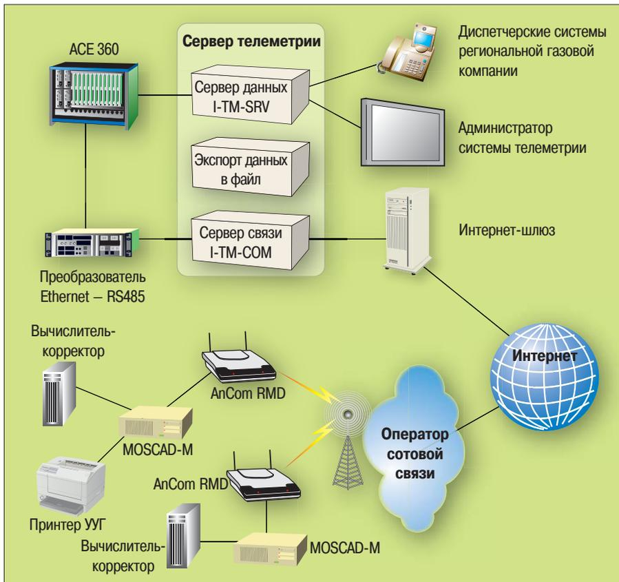
Рис. 4. Схема системы MOSCAD
