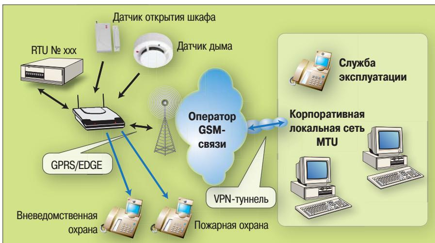
Рис. 2. Коммуникационная система, использующая SMS-сервис
