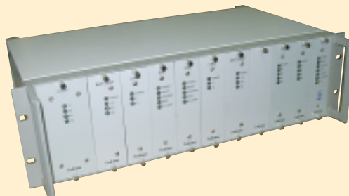
Рис. 6. Имитатор телефонных каналов Canal-5
