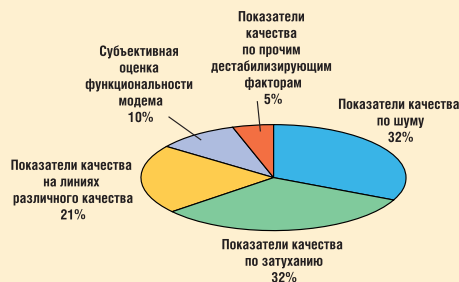
Рис. 9. Распределение весовых коэффициентов основных характеристик модема
