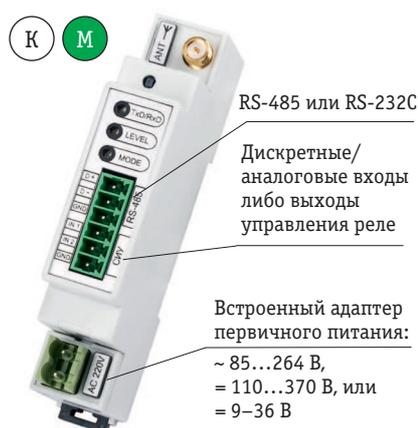
Рис. 1. ZigBee Pro-модем AnCom RZ/B. Крепление на DIN-рейку; диапазон температур: -40...+70 °C
