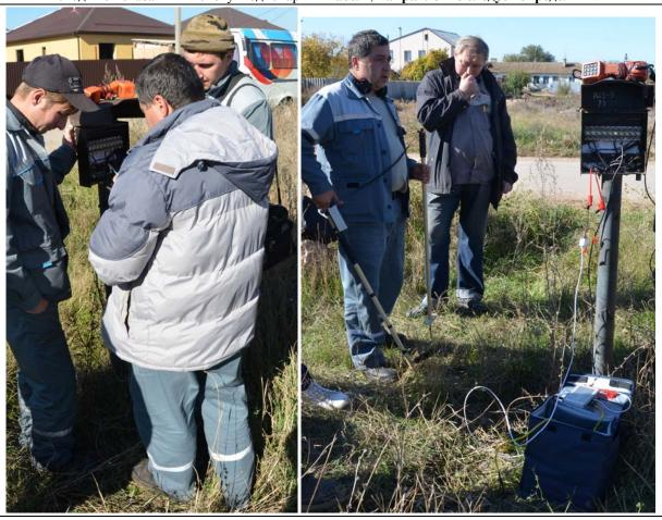
КМС-АК установлен на УКС в целях поиска потерянной абонентской пары. Питание от аккумулятора. Подключение через переходник «под винт». Частота 1020 Гц, непрерывно
