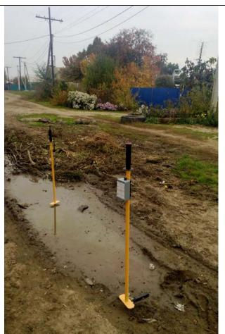
Уровень сигнала на входе «Антенна» за 2 метра до предполагаемого обрыва по показателям искателя КМС-КИ составляет **-117** д $\mathbf{F}$
