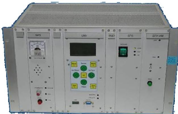
Приемопередатчик обеспечивает совместную работу с панелями дифференциально-фазных ВЧ защит и направленных защит с ВЧ блокировкой всех типов, выполненными на электромеханических реле, полупроводниковых и микропроцессорных элементах.
