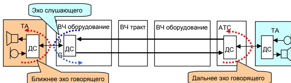
Рисунок 3.2.7 Схема появления эхо сигнала
