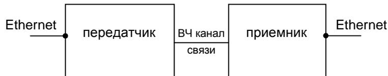
Рисунок 3.6.2 Принцип передачи команд РЗ и ПА в соответствии с МЭК 61850 по ВЧ каналу связи
