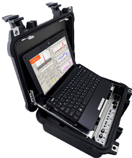
Рисунок 2.3.1. Анализатор ВЧ связи AnCom A-7/307
