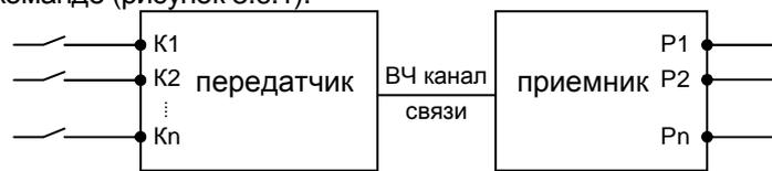
Рисунок 3.6.1 Релейный принцип передачи команд РЗ и ПА по ВЧ каналу связи
