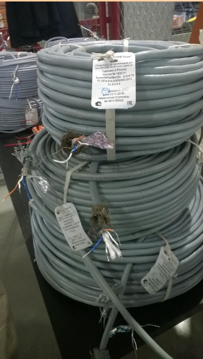
ТехноКIPвКВнг(D) 2\*2\*0,78. Сечение 0,37кв.мм.
