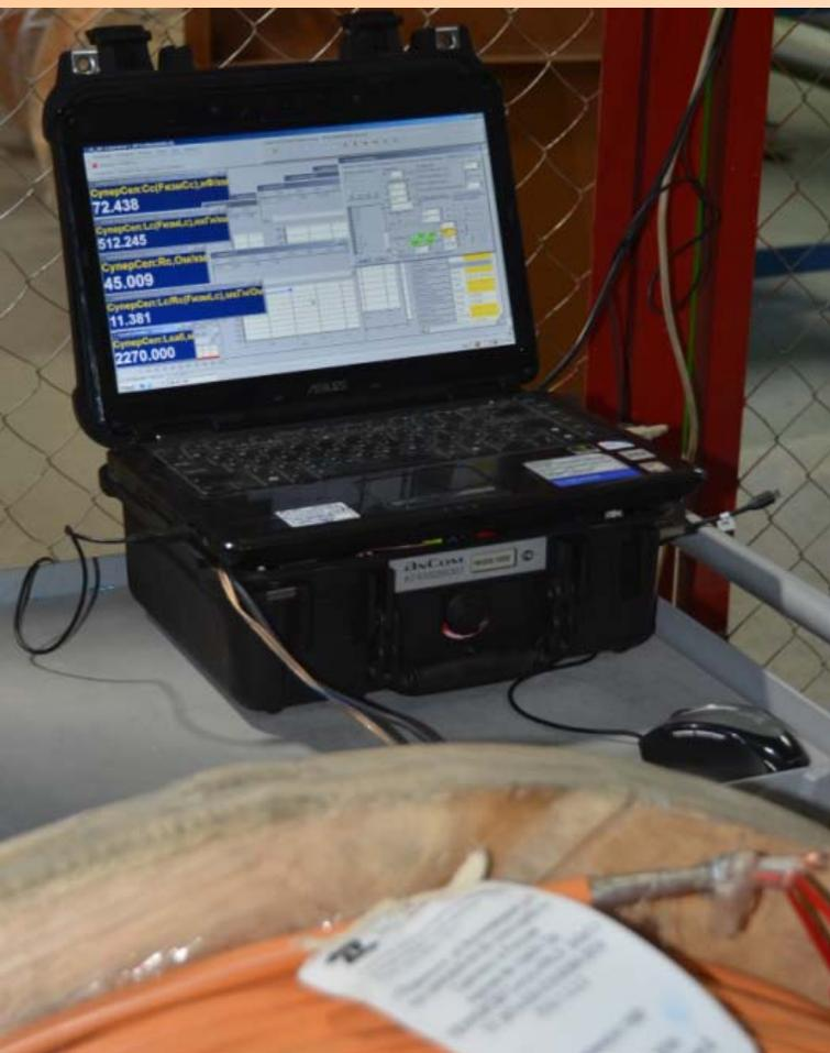
Опробован системный метод измерений индуктивности кабелей.
