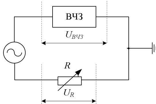
Рисунок 10.8 Схема измерения модуля полного сопротивления ВЧЗ
