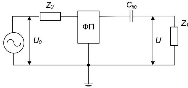
Рисунок 10.9 Схема измерения рабочего затухания ФП
