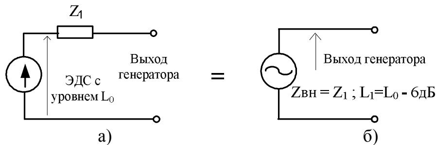
Рисунок 10.1 Эквивалентная схема генератора (а) и её представление современным генератором (б)
