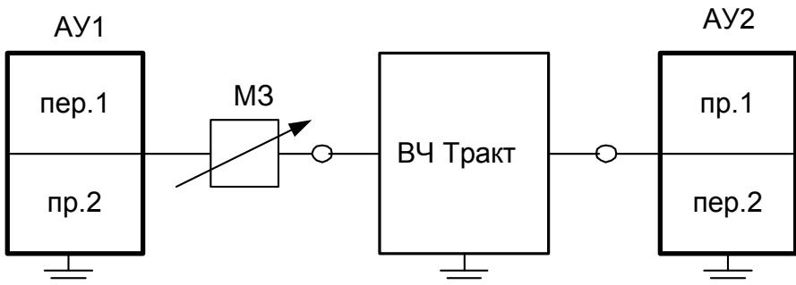
Рисунок 10.14 Схема измерения запаса по затуханию в канале в направлении от передатчика № 1 к приёмнику № 1
