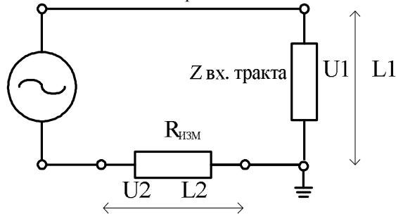
Рисунок 10.6 Схема измерения модуля входного сопротивления ВЧ тракта
