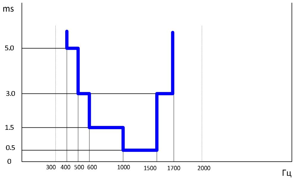
Рисунок 7.6 Шаблон нормирования искажения ГВП телефонного канала с эффективно передаваемой полосой частот 300 - 2000 Гц
