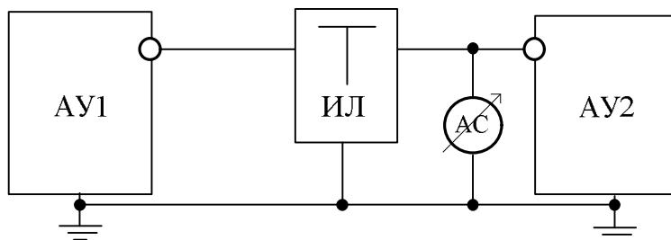
Схема измерения спектра передаваемых сигналов при соединении в канал через ИЛ
