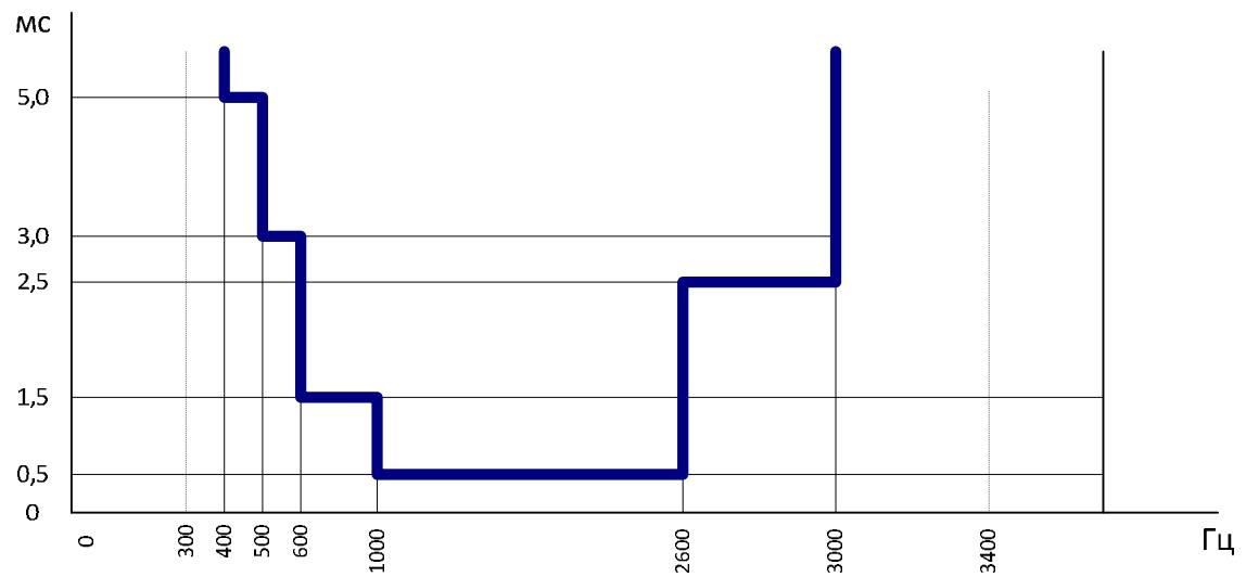
Рисунок 7.4 Шаблон нормирования искажения ГВП телефонного канала с эффективно передаваемой полосой частот 300 - 3400 Гц
