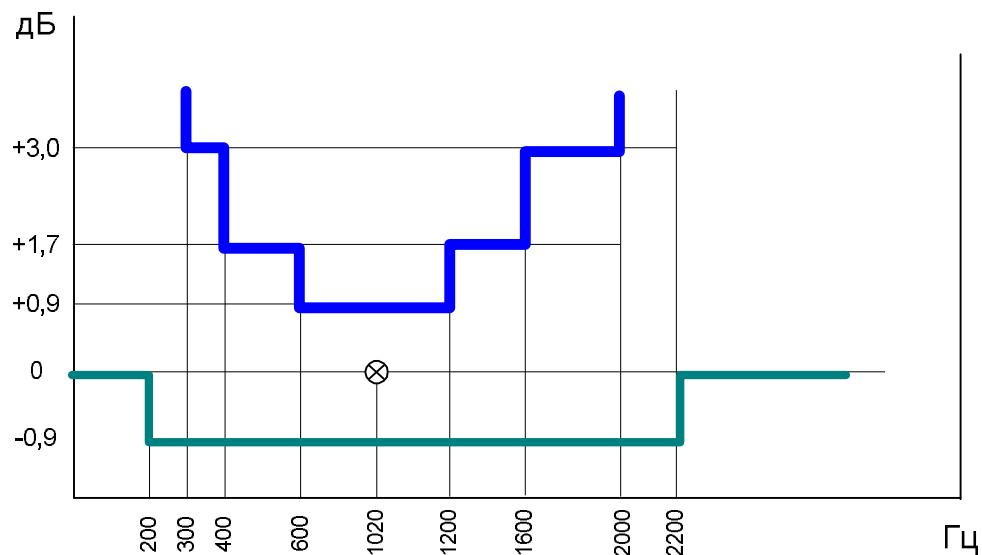
Рисунок 7.3 Шаблон нормирования частотной характеристики относительного остаточного затухания телефонного канала с эффективно передаваемой полосой частот 300 - 2000 Гц
