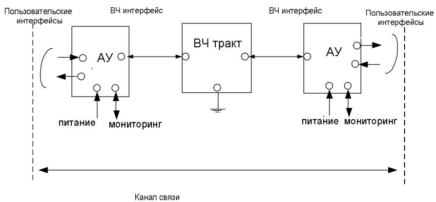
Рисунок 1.1 Структурная схема канала ВЧ связи по ВЛ
