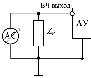
Схема измерения спектра передаваемых сигналов
