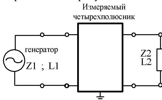
Рисунок 10.2 Схема измерения рабочего затухания четырехполюсника. Рабочее затухание четырехполюсника, измеренное в схеме рисунка 10.2 при известных уровнях  $L_1$  и  $L_2$ , выраженных в дБн, определяется как:
