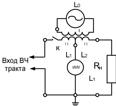
Рисунок 10.5 Принципиальная схема измерения затухания несогласованности входного сопротивления ВЧ тракта
