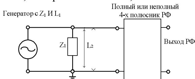
Рисунок 10.12 Измерение затухания, вносимого РФ в параллельно включенный тракт
