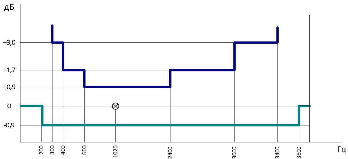
Рисунок 7.1 Шаблон нормирования частотной характеристики относительного остаточного затухания телефонного канала с эффективно передаваемой полосой частот 300 - 3400 Гц
