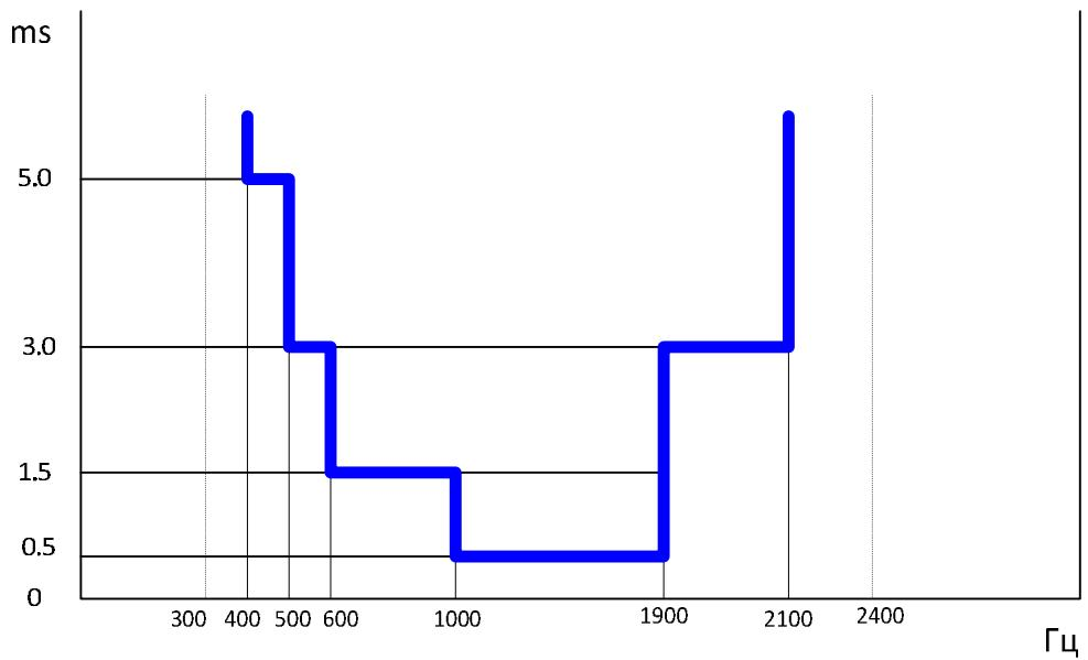
Рисунок 7.5 Шаблон нормирования искажения ГВП телефонного канала с эффективно передаваемой полосой частот 300 - 2400 Гц
