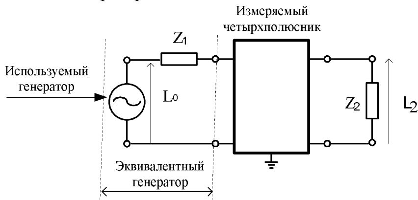
Рисунок 10.3 Схема измерения рабочего затухания четырёхполюсника с эквивалентным генератором
