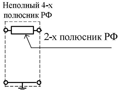
Рисунок 10.11 Представление двухполюсника разделительного фильтра неполным четырехполюсником
