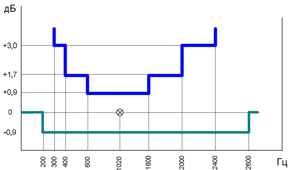
Рисунок 7.2 Шаблон нормирования частотной характеристики относительного остаточного затухания телефонного канала с эффективно передаваемой полосой частот 300 - 2400 Гц
