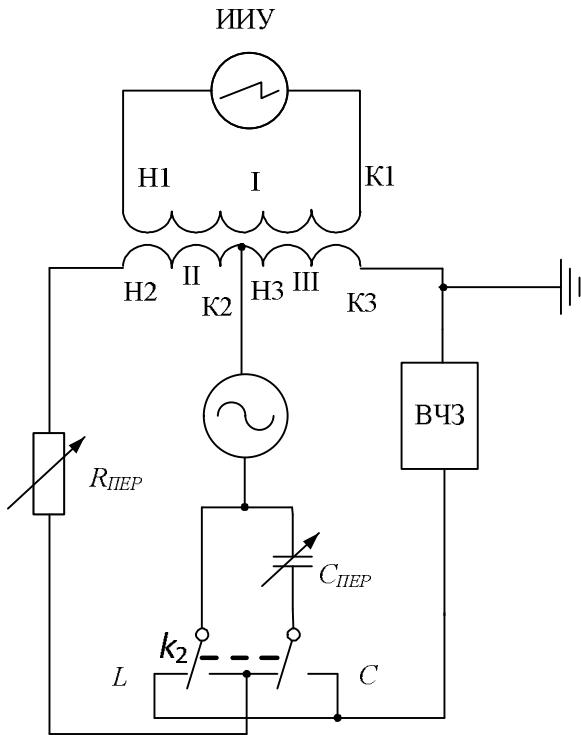
Рисунок 10.7 Схема измерения сопротивления ВЧЗ
