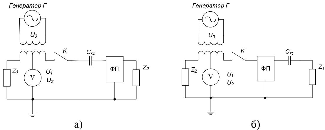
Рисунок 10.10 Схема измерения затухания несогласованности ФП. а) со стороны линии; б) со стороны ВЧ кабеля
