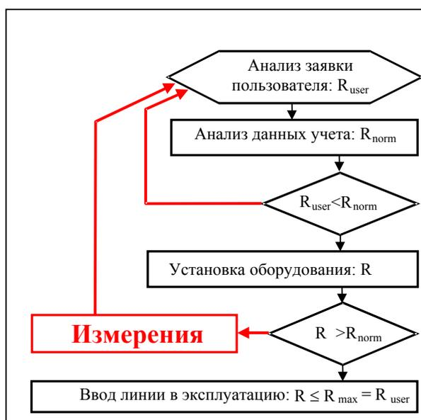
Рисунок 1 - Алгоритм установки цифровой линии
