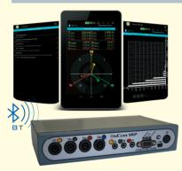
Мобильный и современный ВАФ для настройки и контроля фазочувствительных схем релейной защиты (РЗ) и противоаварийной автоматики (ПА) на предприятиях электрических сетей
