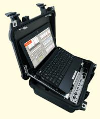
Широко используется эксплуатирующими организациями для проведения измерений в системах связи по воздушным линиям электропередачи (ВЛ – до 1 МГц), а также по распределительным кабельным линиям (КЛ – до 4 МГц): ВЧ трактов, устройств обработки и присоединения, а также комплексного оборудования цифровой и аналоговой ВЧ связи, ВЧ защит, ВЧ терминалов РЗ и ПА, модемов для распределительных сетей 6-10 кВ, аналоговых каналов (в том числе ТЧ).
