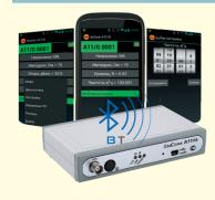
Заменяя снятые с производства модели измерительных генераторов, использовавшихся при измерениях на подстанциях, генератор AnCom A11/G позволяет формировать гармонический сигнал 10...1024 кГц (шаг 1 Гц) с уровнем 0,004...6,5 В (шаг 0,001 В) – для решения измерительных задач при пуско-наладке, настройке и проверке ВЧ аппаратуры и каналов связи РЗ и ПА, оборудования присоединения, ВЧ трактов каналов связи по ЛЭП.
