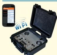
Имитатор затухания и шума в ВЧ тракте AnCom ИЗШ-75 представляет собой Искусственную Линию (ИЛ) с расширенным функционалом:
