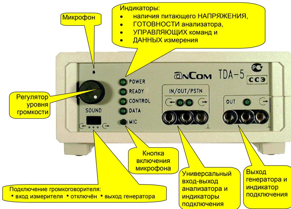
Рис. 1 Лицевая панель анализатора AnCom TDA-5
