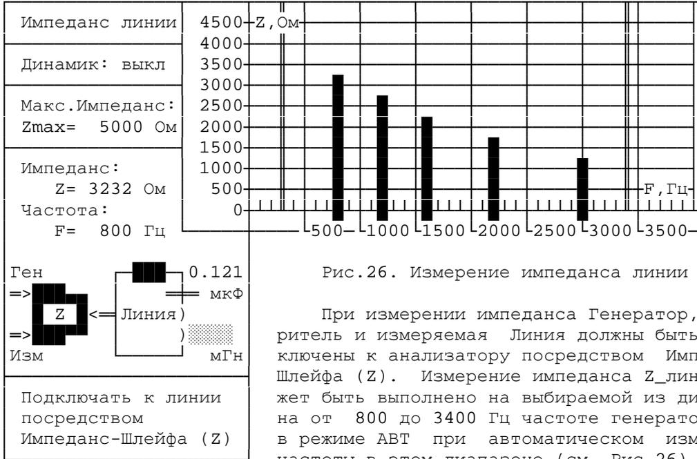
На частоте 800 Гц помимо измерения импеданса автоматически производится измерение емкости [мкФ] или индуктивности [мГн] линии.
