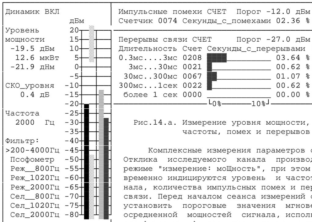
Рис.14.а. Измерение уровня мощности, частоты, помех и перерывов
