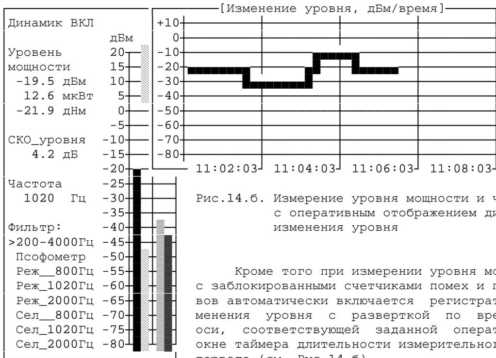
Рис.14.б. Измерение уровня мощности и частоты с оперативным отображением динамики изменения уровня
