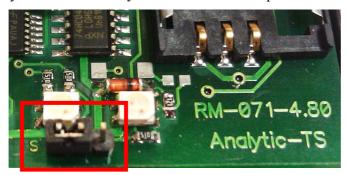
• извлечь ответную часть из разъема подключения проводного канала связи.
