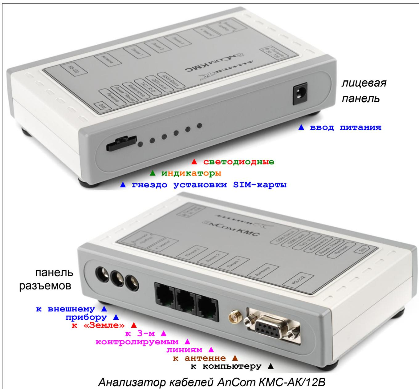
После подачи питания и при наличии установленной SIM-карты КМС-АК регистрируется в соответствующей сети подвижной радиотелефонной связи (СПС), после чего управляется путем вызова (звонка) с любого телефона и передачей DTMF-команд, на которые отвечает речевыми сообщениями и выполняет соответствующие командам коммутацию, измерение, генерацию.
