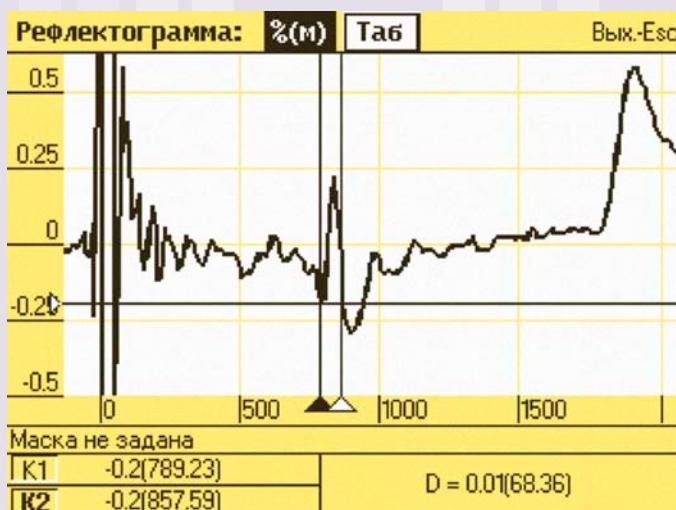
3. Рефлектометр показывает конец линии на отметке 1769,71 м и дефект протяженностью около 68 м на удалении от точки подключения равном 789,23 м. Такой дефект может являться следствием расщепления пары, в результате чего и возникает существенное переходное влияние – см. Спектр помех. Помимо рефлектограммы измерены электрические параметры кабельной пары:
