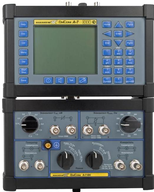
Анализаторы обеспечивают измерение параметров и характеристик коаксиальных и симметричных кабелей связи, каналов и линейных трактов, образованных с применением любых направляющих систем и соответствующего оборудования. Кроме того, анализаторы обеспечивают измерение каналов тональной частоты (ТЧ), образованных в любой среде передачи, а так же параметров оконечного и транзитного оборудования связи.
