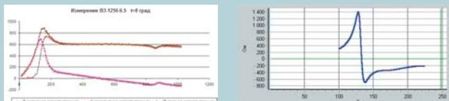
Измерение высокочастотного заградителя (ВЧЗ) и элементов его настройки с целью определения эффективной полосы заграждения (активная, реактивная составляющие и модуль полного сопротивления).
