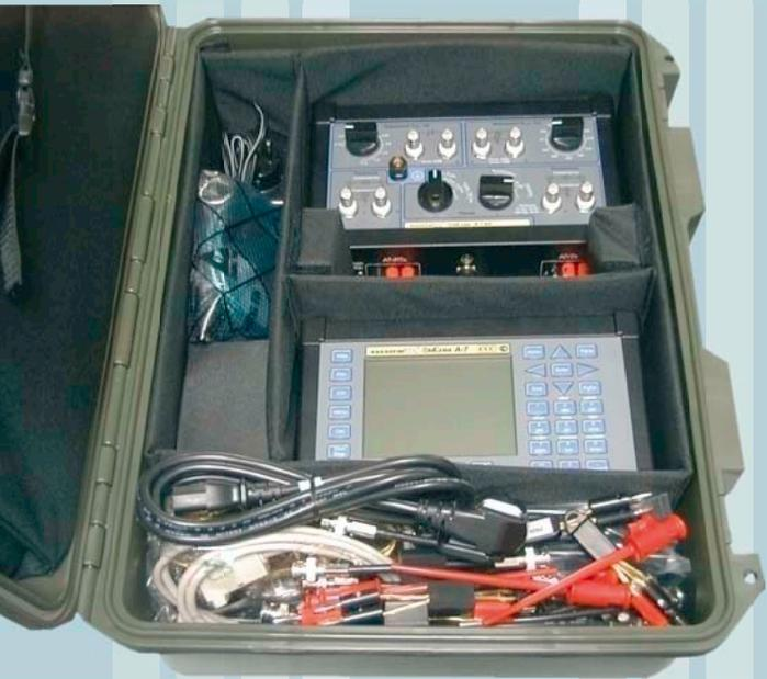
Анализатор AnCom A-7 предназначен для измерений в полосе частот до 1 МГц в системах ВЧ-связи по ЛЭП и до 4 МГц в системах связи по распределительным кабельным сетям:
