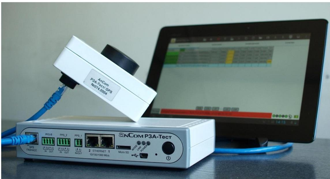
Приборный блок анализатора оснащен встроенной аккумуляторной батареей (АКБ) для работы в автономном режиме, в том числе для обеспечения питания устройства синхронизации.
