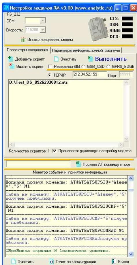
Удаленная настройка производится только с включенным протоколом ATSWP и только для режимов «CSD\_mode» и «Internet\_CSD\_mode» (комбинированный режим, который включает в себя «Internet\_mode» и «CSD\_mode»). Версия встроенного ПО удаленного модема должна поддерживать возможность удаленного конфигурирования. Для локального и удаленного конфигурирования параметров модема может использоваться один формат скриптов, совместимый со скриптами для ПО GTem.
