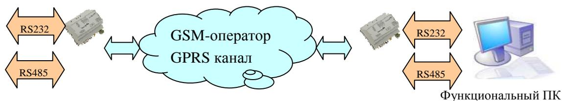
Схема целесообразна для демонстрации прямого радио удлинителя интерфейсов, в том числе при использовании модемов с двумя интерфейсами RS-232C и/или RS-485
