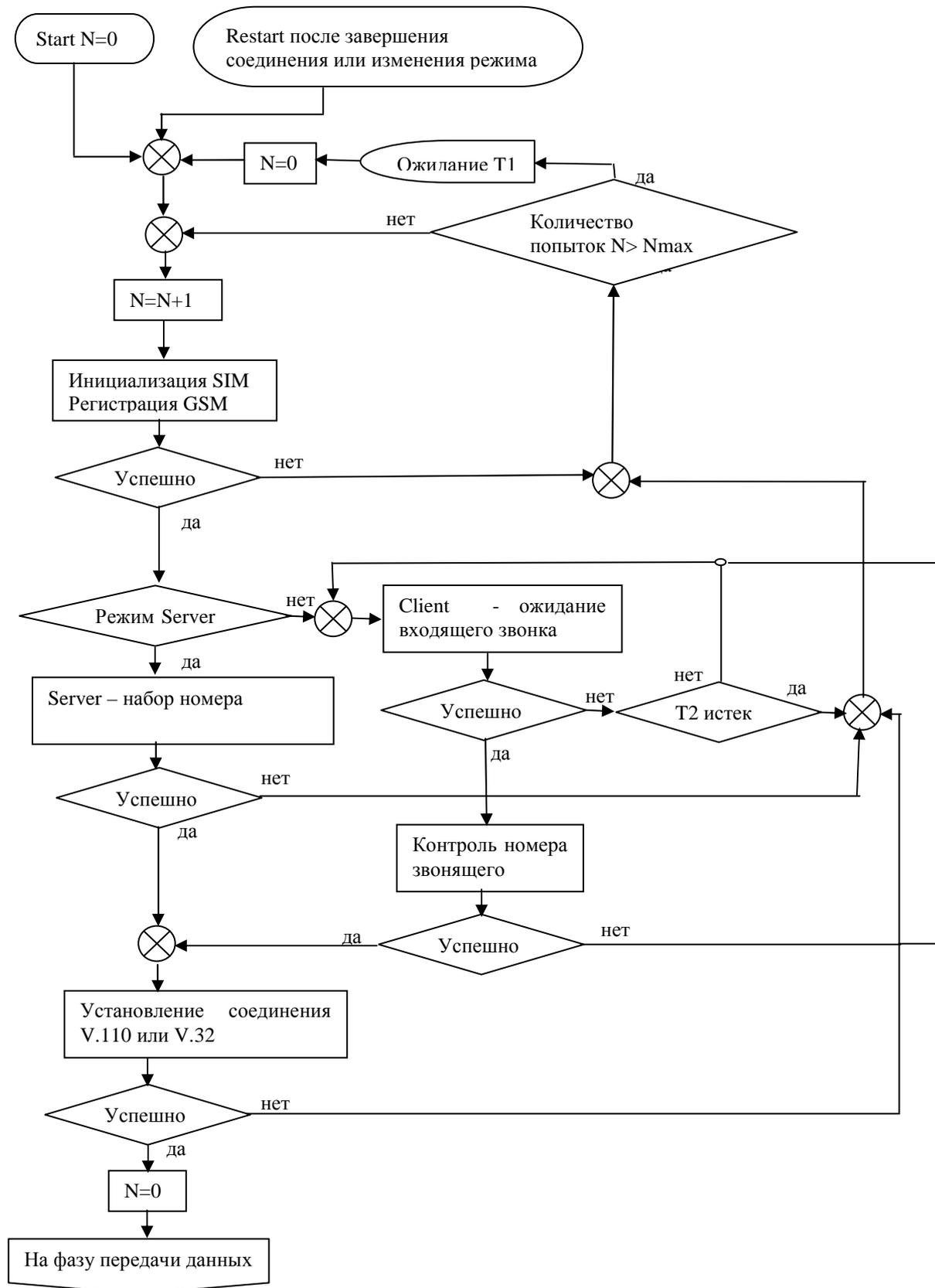
2.3.7 Блок схема фазы передачи данных в режимах: Socket, CSD, Internet, Internet\_CSD, Internet\_CSD\_Server. Установка параметров:
