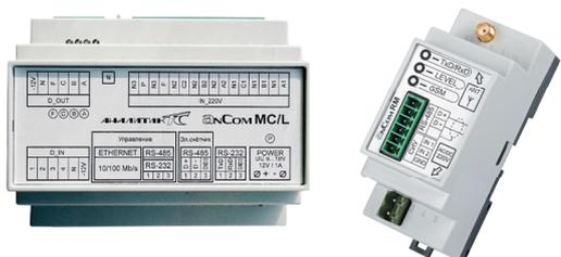
Автоматическое управление линиями светильников утром и вечером: расчет светового дня местности по алгоритму «Гражданские сумерки», ввод поправочных коэффициентов
